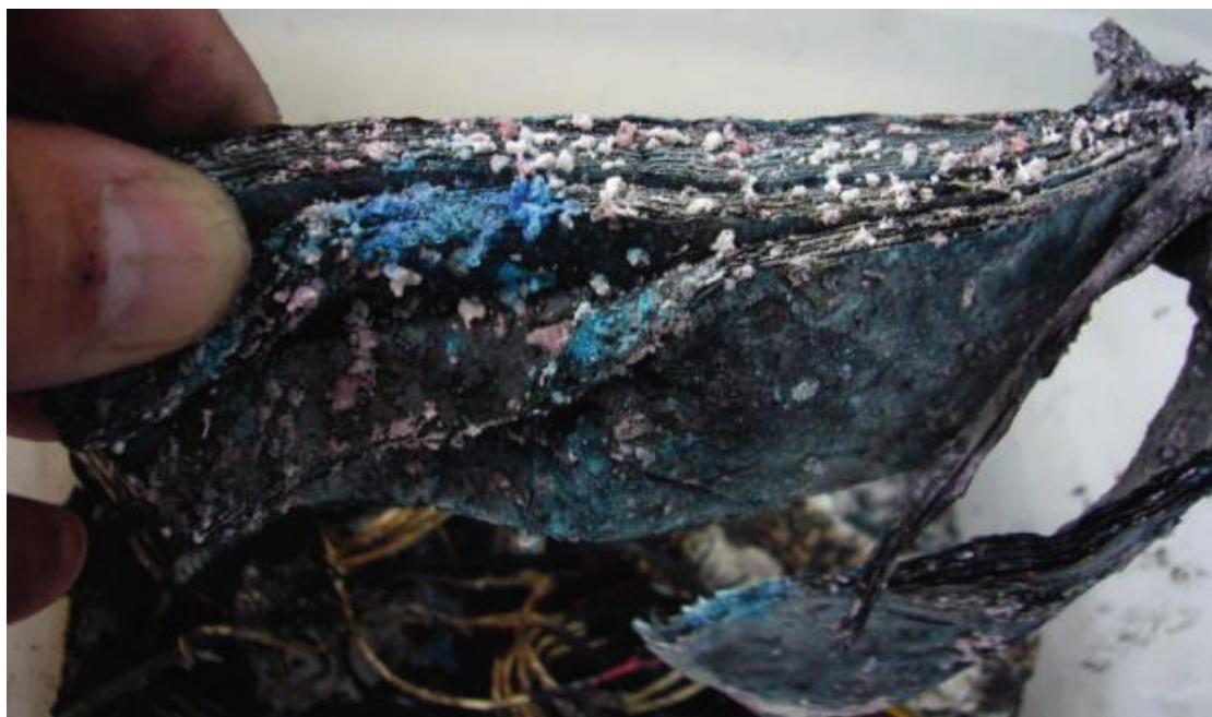
Abbildung 26: Batteriezelle (LMC) nach einem Brand. Die Zelle ist komplett ausgebrannt (alle organischen Komponenten wie Hülle, PE Separator Folie und Elektrolyt und auch die Graphit Elektrode). Während einer Reparatur am E-Scooter wurde die Zellenhülle mit einer Schraube durchstossen. Der innere Kurzschluss entzündete nach einigen Minuten die freigesetzten Gase. Weder Wasser noch Schaum- und Staublöcher vermochten den Brand vollständig zu löschen – erst als die Zellen vollständig entladen waren, stoppte der Schwelbrand; deutlich sieht man das blaue Kupfersulfat, das sich durch die Löschmittel bildete. (Bild: Empa)
