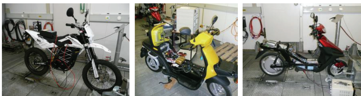
Abbildung 46: E-Scooter auf dem Empa Rollenprüfstand. Von links nach rechts Quantya ‚Evo 1‘; Oxygen ‚Postscooter‘; Mobilec ‚Mobilec‘. (Bilder: Empa)
