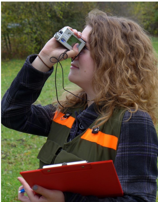
Figure 2. Mesure de hauteur avec le Vertex (photo Urs-Beat Brändli)
