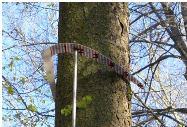
Figure 1. Mesure du diamètre à 7 mètres avec le compas finlandais (photo Markus Keller)
